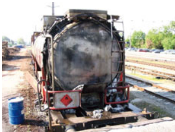
Schade door brand bij appendage
